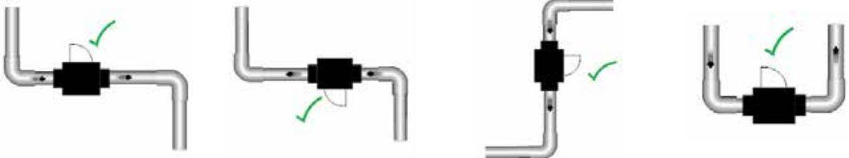
NOTA: Al seleccionar una ubicación física para instalar FlowVis®, asegúrese de permitir el acceso para leer la escala en la tapa.
