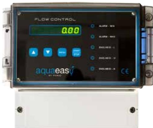
Se puede configurar como medidor de flujo o controlador de flujo en el momento de la puesta en marcha. En el modo de medidor de flujo, la velocidad de flujo real se muestra y supervisa mediante un relé de alarma. En el modo de controlador de flujo, la bomba de filtro se controla según los caudales establecidos. Tres caudales programables por el usuario.
