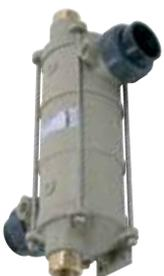
Intercambiador de calor vertical con elemento titanio o acero inoxidable 316. La presión de trabajo es primaria 5 bar y secundaria 4 bar. La versión con titanio es muy adecuada para agua agresiva y / o aplicación en piscinas con sistemas de electrólisis salina. El HI-Temp viene con acoplamientos y tamaños de conexión de 50 mm / 1" (piscina / CV).
