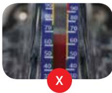
3. La clapeta indicadora se ve demasiado atrás / frente de la tapa
