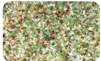
\* Para filtros más pequeños (<1000 mm de diámetro) y para todos los filtros con colector de placa independientemente del diámetro del filtro, utilice 70% de PGFM grado 1 y 30% de PGFM grado 2. PGFM grado 3 es para filtros de mayor diámetro para asegurar filtración adecuada.
