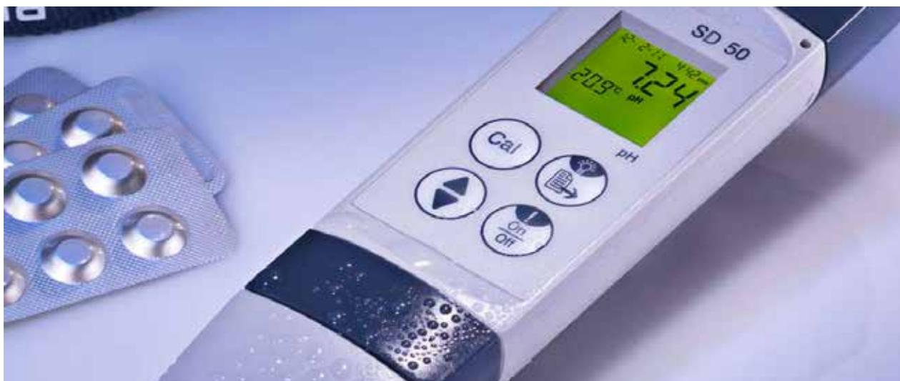
La serie SD comprende una gama de instrumentos portátiles compactos y fáciles de usar para la medición precisa de pH, ORP, Conductividad, TDS o sal. Con una carcasa robusta y totalmente impermeable (IP67), estos medidores son la solución ideal para realizar pruebas in situ en aplicaciones ambientales, industriales o de piscinas y spas.
