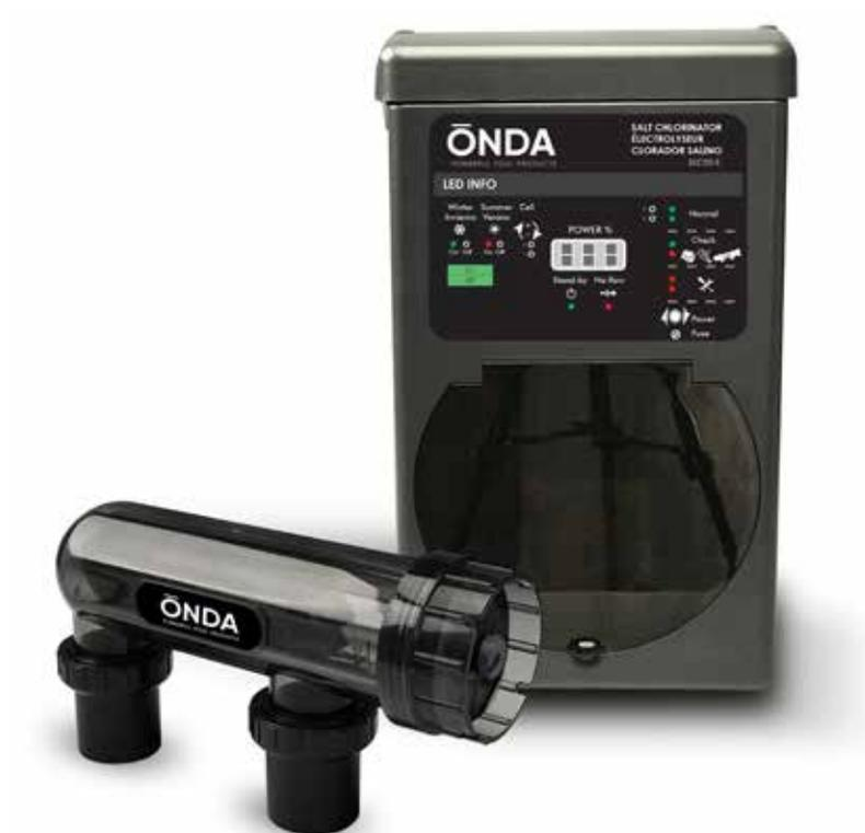
Los cloradores salinos ONDA utilizan un método alternativo de desinfección de piscinas basada en el proceso de electrólisis. Cuando la solución de agua salada pasa a través de la célula electrolítica, el cloruro de sodio (sal) se convierte en dicloro (gas), que al disolverse en el agua se convierte en hipoclorito sódico (cloro líquido).
