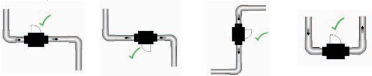
NOTA: Al seleccionar una ubicación física para instalar FlowVis®, asegúrese de permitir el acceso para leer la escala en la tapa.
