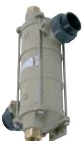
Intercambiador de calor vertical con elemento titanio o acero inoxidable 316. La presión de trabajo es primaria 5 bar y secundaria 4 bar. La versión con titanio es muy adecuada para agua agresiva y / o aplicación en piscinas con sistemas de electrólisis salina. El HI-Temp viene con acoplamientos y tamaños de conexión de 50 mm / 1" (piscina / CV).
